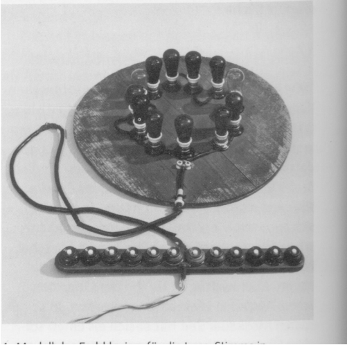
12 Eenvoudig model van een kleurenorgel dat Alexander Skrjabin wilde gebruiken voor de lichtpartij in de uitvoering van 'Prometheus: Gedicht van vuur' (1911).
